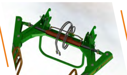
Гидроцилиндр двухстороннего действия жестко закреплен в корпусе рамы
