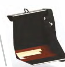
Коробчатое сечение основания «отвала»
