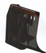
Усиление верхней кромки отвала
